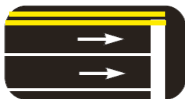
H4 Marcas transversales Línea de detención
